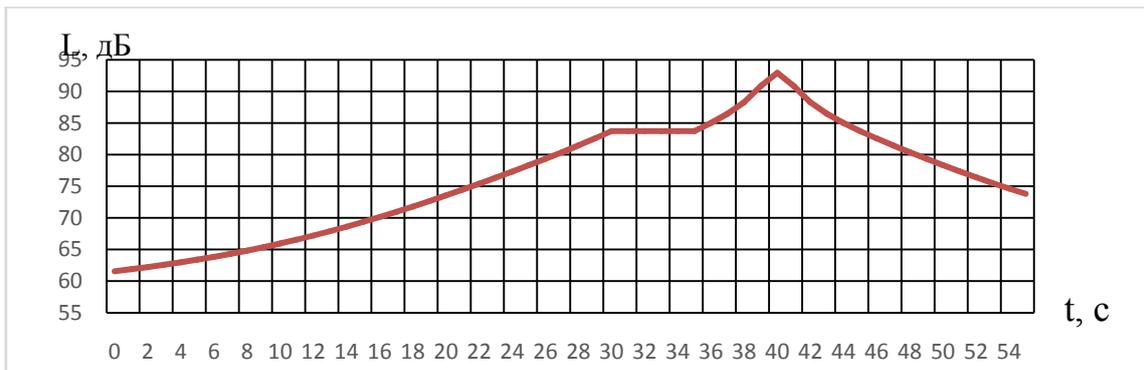
Рисунок 3. График шумового воздействия на оператора за один цикл обслуживания оборудования
