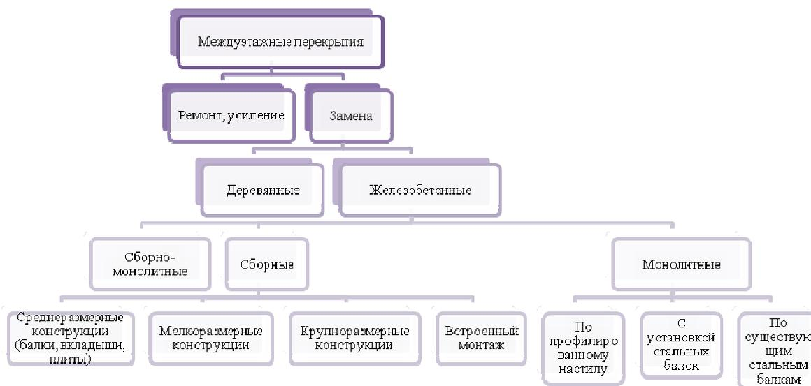
Рисунок 2 – Варианты ремонта или замены междуетажных перекрытий при реконструкции жилых зданий
