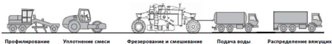
Рисунок 3 – Технологическая схема укрепления грунтов
